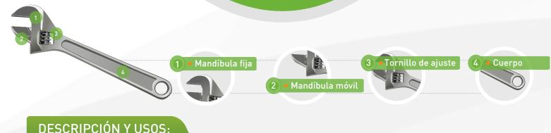
Consta de una pieza fija metálica y otra pieza móvil que se ajusta mediante un hilo sin fin. Algunas cuentan con mango de material aislante y pueden ser utilizadas en trabajos eléctricos.
